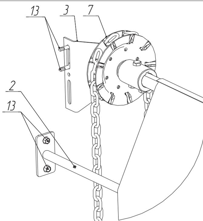
2.1. МОНТАЖ НА ГЕРМЕТИЗАТОР СО СКЛАДНОЙ СТАЛЬНОЙ РАМОЙ.
