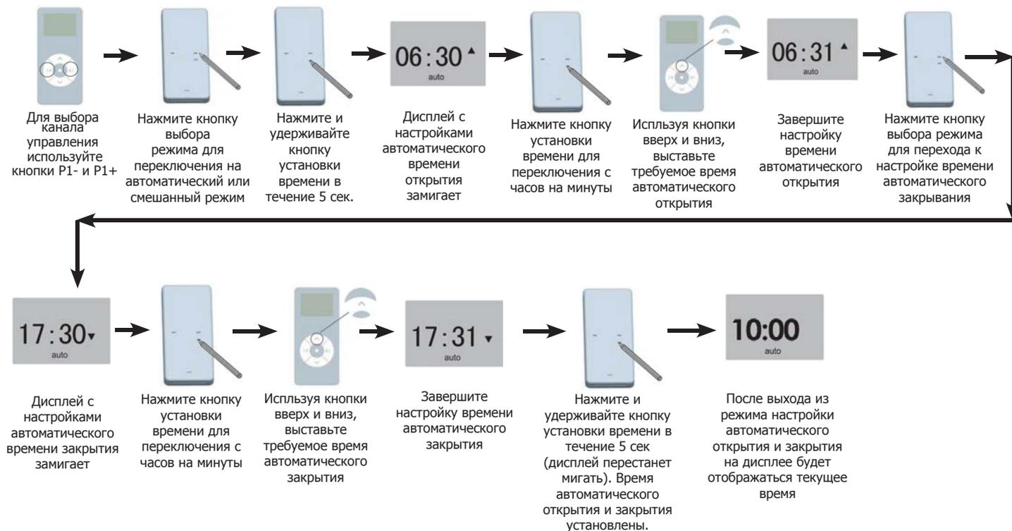
⚠ Настройка таймера возможна только при выбранном автоматическом либо смешанном режиме.
