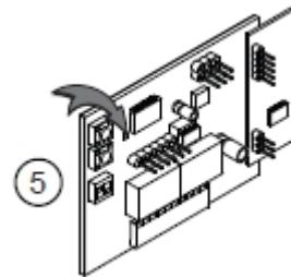
6) Для программирования второго канала нажмите 1 раз кнопку Sw2.
